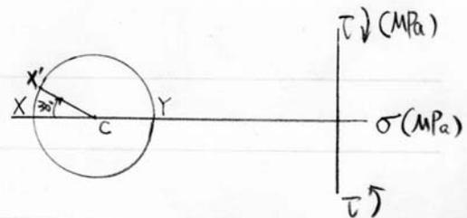
③  $R = CX = (-2.4 \text{ MPa}) - (-3 \text{ MPa}) = 0.6 \text{ MPa}$
